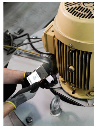
Sensor mithilfe der Schaeffler Optime App aktivieren und einbinden.
